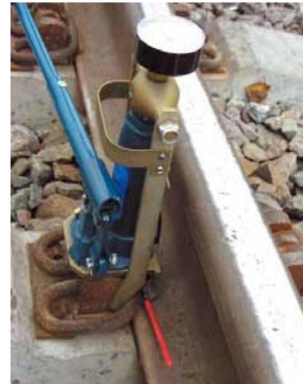
**Рис. 14.** Прибор для измерения усилия прижатия рельса
