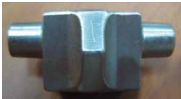
**Рис. 11.** Монорегулятор из стали 45
