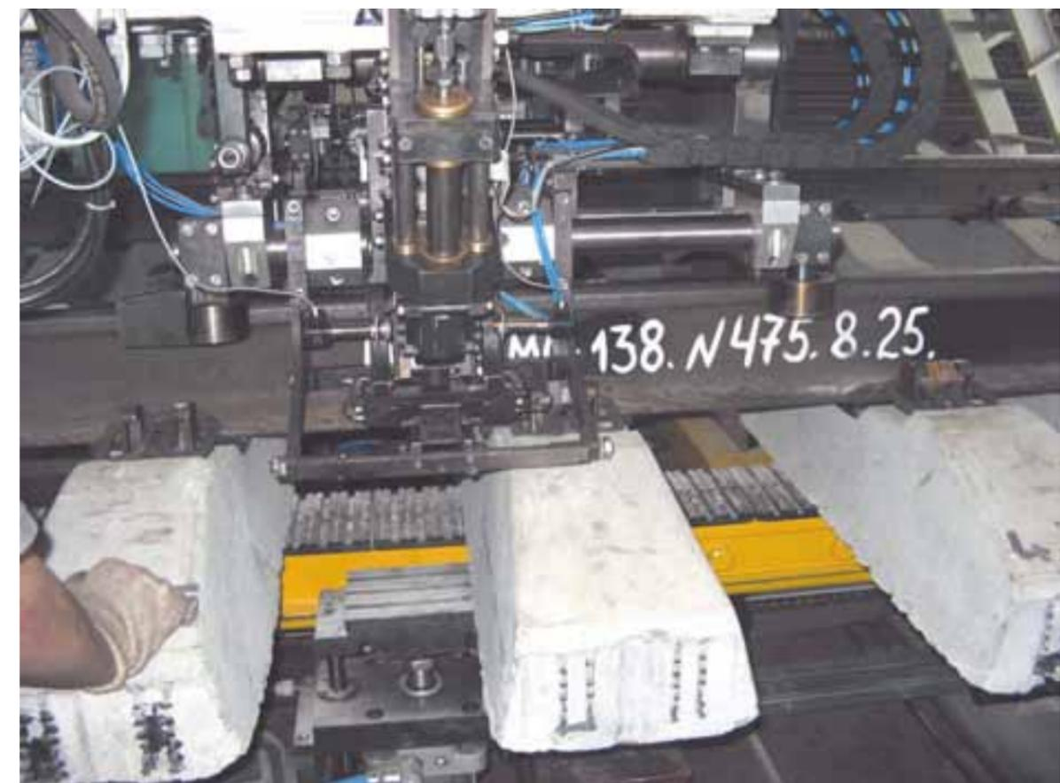
**Рис. 4.** Автоматическая линия по сборке рельсошпальной решетки (продолжение)
