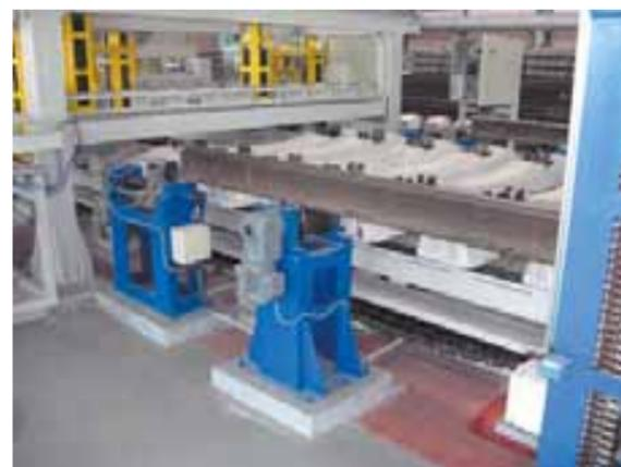
**Рис. 4.** Автоматическая линия по сборке рельсошпальной решетки
