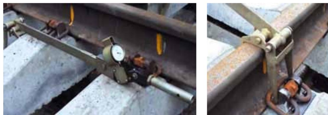
**Рис. 21.** Устройство для измерения силы прижатия пружинной клеммы
