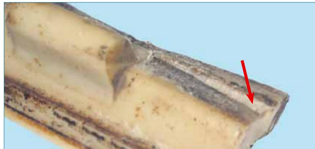
**б) Деформация уголка изолирующего при анкерах 1-го исполнения**
